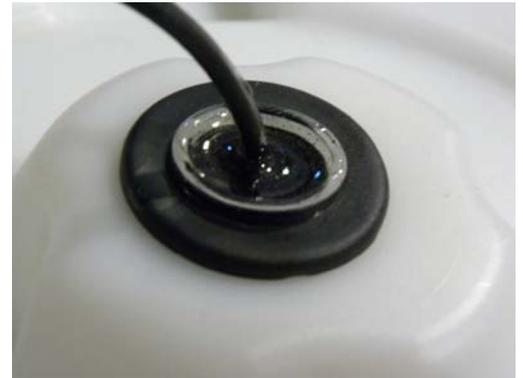
J. Positionner la lumière pour que le fil soit du même côté que le câble d'alimentation principal. S'assurer que le fil de la lumière soit aligné avec les petites cavités dans la base de service pour éviter que celui-ci ne soit écrasé lorsque le capot sera en place.
