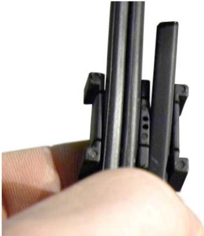
Mettre ensuite la partie supérieure du connecteur sur la partie inférieure, en vous assurant que les fils sont bien à plat.
